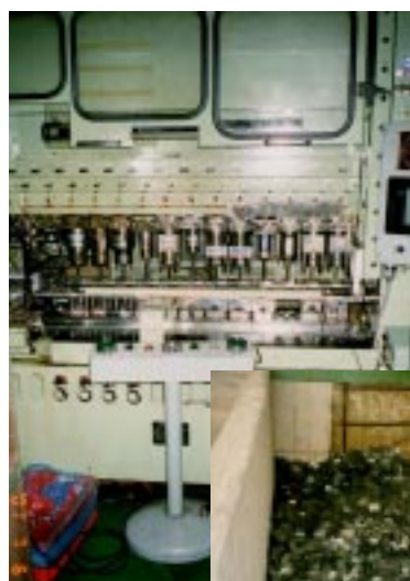
江蘇マブチに設置してある高速プレス機 (中国江蘇省呉江市)
