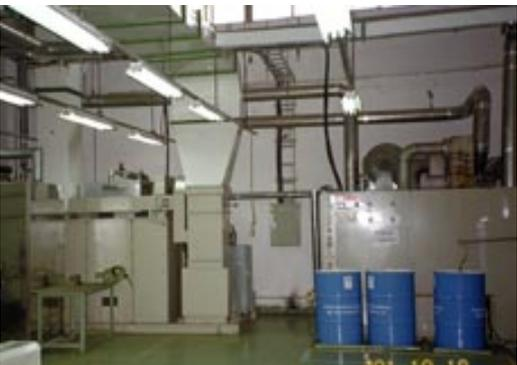
洗淨機及び洗淨液容器に全て設置されている漏れ防止用受け皿（中国大連マブチ）
