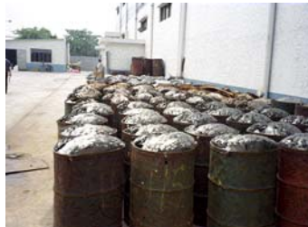
プレス加工の歩留り率を高めるとともに、抜きカスの再利用も積極的に推進しています。現在、グループ内で発生する抜きカスは100%再利用されます。上図は回収トラックへの積み込み待ちの抜きカスです。
