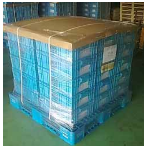
使用量を適正化したストレッチフィルム梱包例
