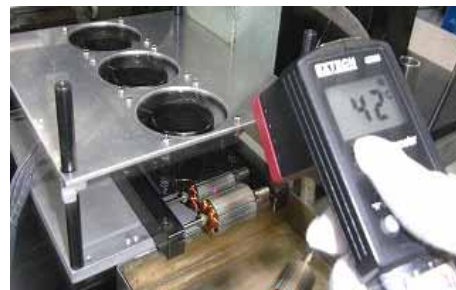
改善後:軸流ファンに置き換えてワークを冷却
